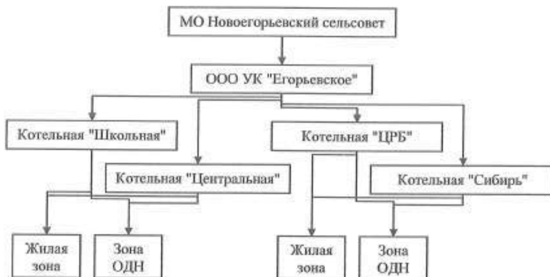
Рисунок 2.1.1 – Схема централизованного теплоснабжения потребителей МО
